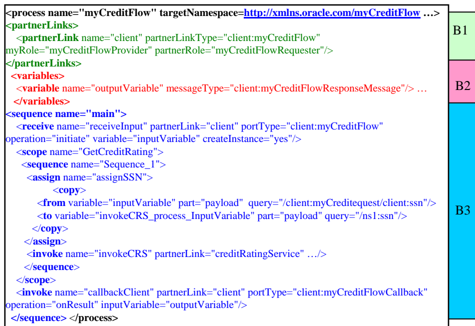
Figure 1. La structure principale du fichier XML d'un processus BPEL
